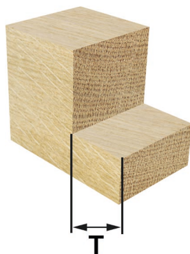
Drei Falztiefen mit einem Fräser
