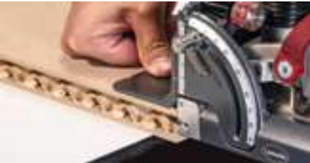
Hoekaanslag aanbrengen en eerste groef frezen
