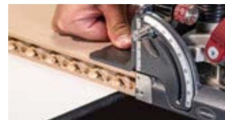
Zeta P2 met behulp van positioneringsclip in boring uitlijnen en volgende groef frezen*
