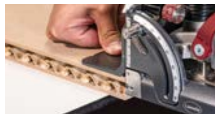
Hoekaanslag aanbrengen en eerste groef frezen
