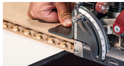
Zeta P2 met behulp van positioneringsclip in boring uitlijnen en volgende groef frezen*
